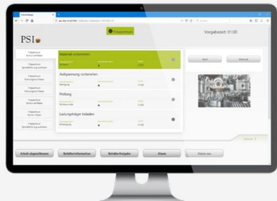
Abbildung: Das Werker-Cockpit unterstützt Mitarbeiter in der Produktion im Arbeitsablauf inklusive Grafiken und ablaufabhängigen Verfahrensweisungen.
