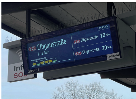
Auslastungsanzeige am Bahnsteig.
