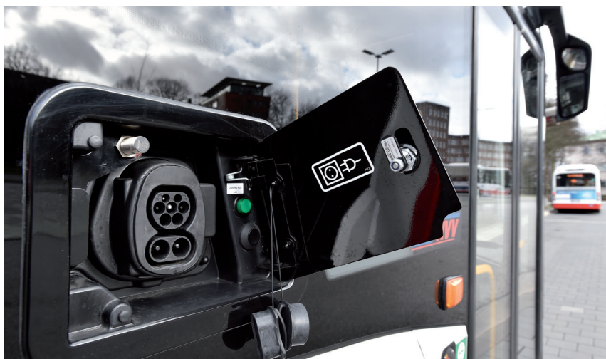
Plug-in Ladebuchse eines Solaris-Busses.
